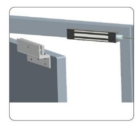
Paso 1: Debe haber 2 arandelas de metal y arandela de goma entre la placa y el soporte en forma de Z. Poner la arandela de goma entre 2 arandelas de metal. Bloquee el tornillo superior plano en el centro de la placa a la placa en forma de Z.
